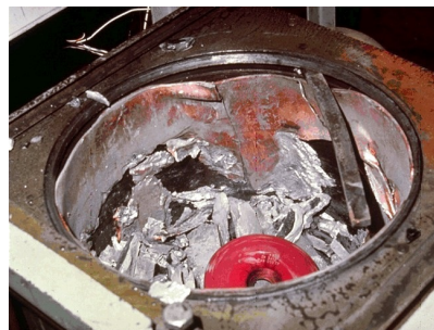
不適切な取扱による ロータ事故の例
